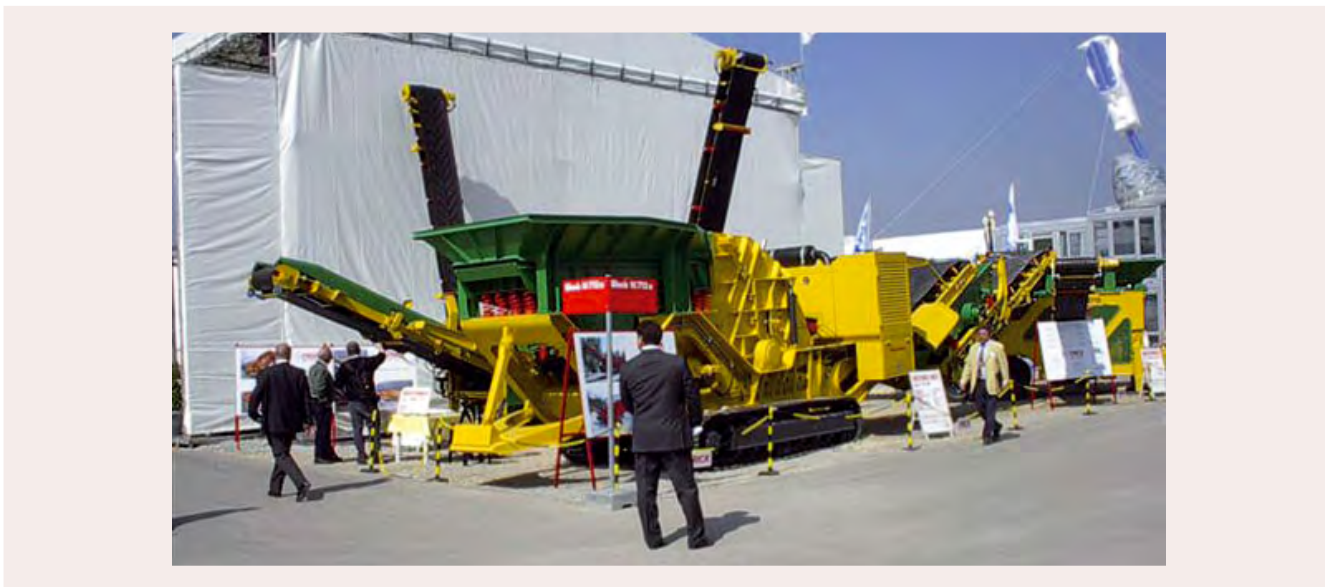
Obrázok 15: Mobilná recyklačná linka na pásovom podvozku (zdroj: https://www.asb.sk/stavebnictvo/stavebna-technika/recyklacne-zariadenia-na-spracovanie-stavebneho-odpadu )
