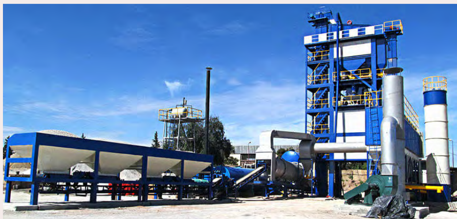
Obrázok 12: Obalovačka – výrobná linka na asfaltový betón
