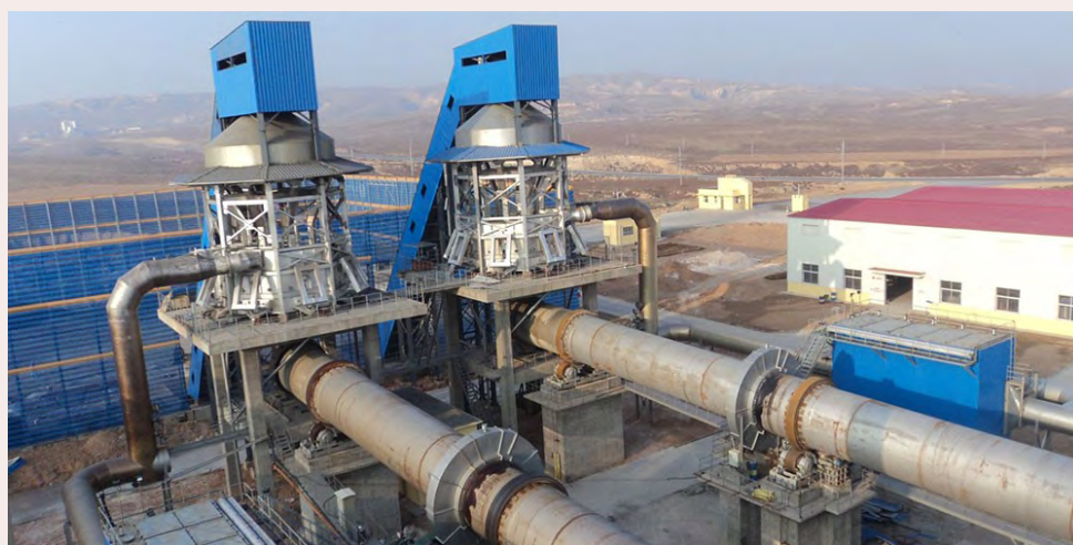
Obrázok 4: Rotačná pec na výrobu magnezitu (zdroj: http://www.zkeqpt.com/uploads/160926/1-1609261133004b.jpg )
